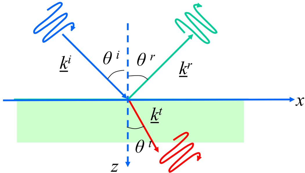
Onda piana uniforme che incide obliquamente sulla superficie di separazione tra due mezzi lineari, omogenei, isotropi, stazionari, non dispersivi e non dissipativi ( $\epsilon_1, \mu_1, \sigma_1=0, \epsilon_2, \mu_2, \sigma_2=0$ )
