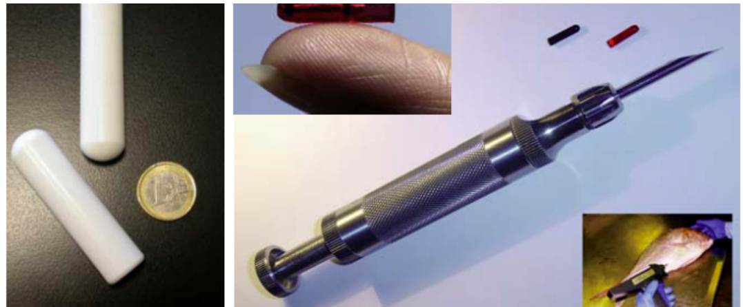
Figura I.18 A sinistra, TAG per uso animale: in ceramica da inserire nello stomaco dei bovini. Al centro e a destra "food-safe" RFID TAG, iniettabile [28] in prodotti alimentari (nella foto un pesce), ricoperto in plastica chirurgica, dimensioni 11 x 2.7 mm, modalità read/write, frequenze 134.2 o 125 kHz, resistente a temperature da -50°C a 160°C pressione fino a 900 bar ENSID Technologies
