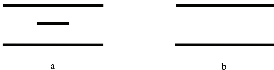
Fig. 4: Sezione di una linea a striscia (stripline) a) bilanciata o schermata b) sbilanciata
