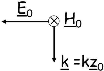
Il campo elettrico  $\underline{E}_0$  ed il campo magnetico  $\underline{H}_0$  sono perpendicolari fra di loro e perpendicolari alla direzione di propagazione  $\underline{k}$  (TEM)
